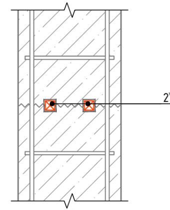
\* допускается замена на профиль набухающий ТЕХНОНИКОЛЬ ФУНДАМЕНТ Б 15x25 или Р 4x20.
